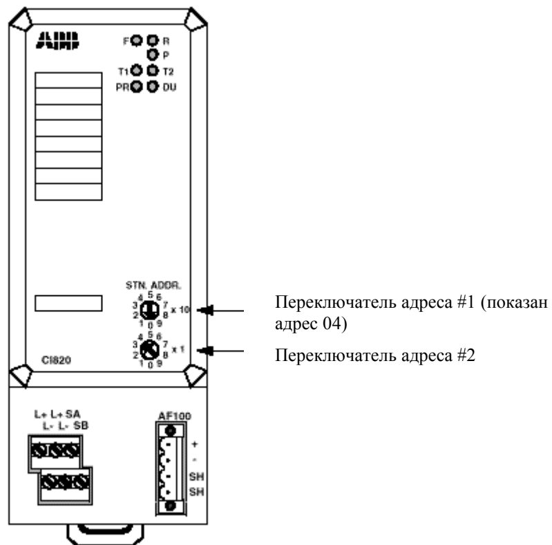
Рисунок 3-7. Передняя панель модуля интерфейса связи CI820
