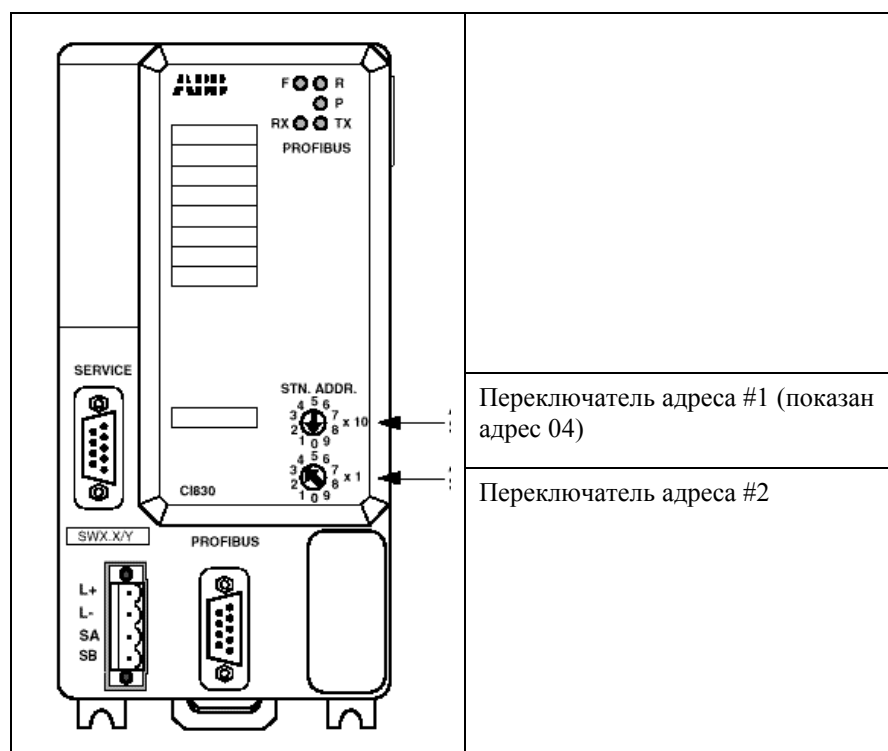
Рисунок 3-8. Передняя панель модуля интерфейса связи CI830
