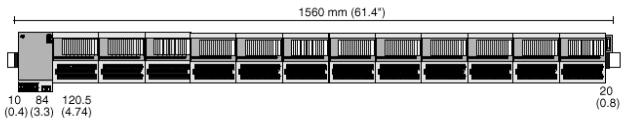
Рисунок 1-22. Горизонтальная установка ТБ станции ввода/вывода S800 (компактные)
